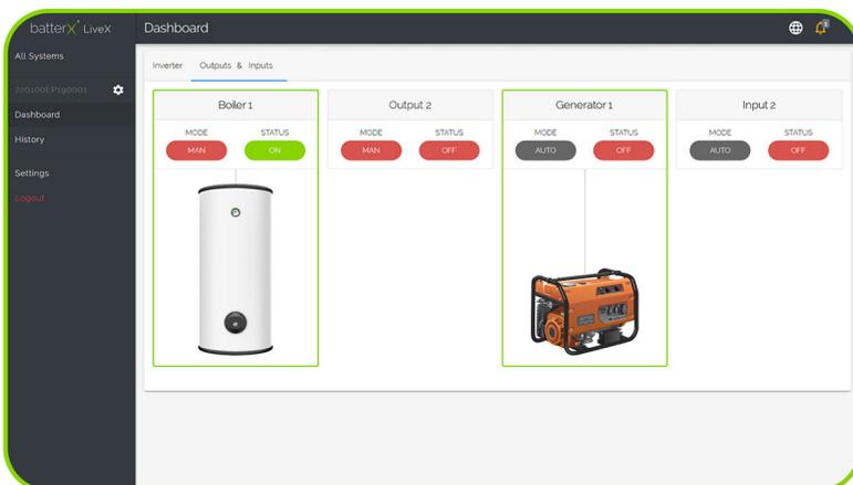
Smart wird das Energiemanagement durch programmierbare Relaiskontakte, welche elektrische Verbraucher (Geräte) und alternative Energiequellen, wie etwa einen Dieselgenerator, ansteuern können.
